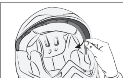
Retirez la partie avant en détachant doucement l'intérieur le long du cadre. Pour faciliter l'opération, commencez par le côté C du cadre.
