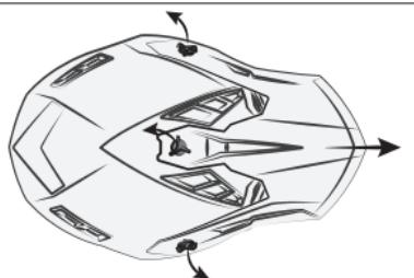
Remova os três parafusos na viseira e arruelas.
