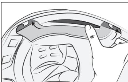
Τέλος τοποθετήστε τα πλαστικά κλίπς τοποθετώντας τα στους κατάλληλους χώρους.
