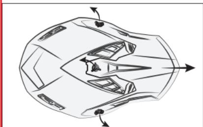
Retire los tres tornillos presentes en la visera junto con las arandelas.
