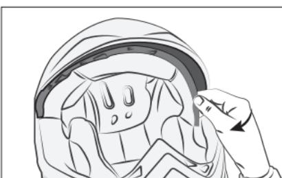
Retire la parte frontal desenganchando cuidadosamente la parte interna a lo largo del armazón. Para facilitar la operación, comience por el lado c del armazón.
