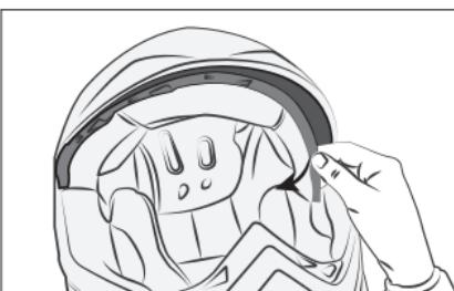
Entfernen Sie die Vorderseite, indem Sie die Innenseite entlang des Rahmens vorsichtig lösen. Um den Vorgang zu erleichtern, beginnen Sie mit der Seite des Rahmens.
