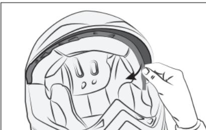
Rimuovere la parte frontale sganciandolo l'interno lungo il telaio delicatamente. Per facilitare l'operazione partire dal lato del telaio.
