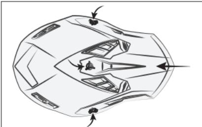
Appoggiare la visiera e fissare tramite le viti e rondelle.
