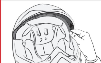
Infilare la parte in plastica incastrandola negli appositi spazi lungo il telaio plastico.
