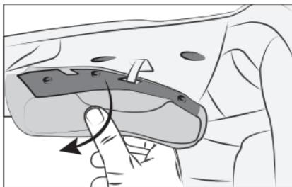
Ziehen Sie die Knöpfe heraus, die das Wangenpolster befestigen, und entfernen Sie es. Ziehen Sie das Wangenpolster vom Riemen aus.
