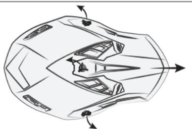
Entfernen Sie die drei Schrauben am Visier sowie die Unterlegscheiben.
