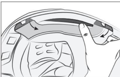
Entfernen Sie die seitlichen Kunststoffklammern.
