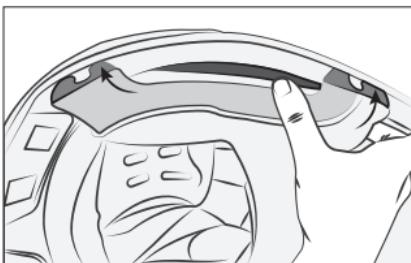
Führen Sie anschließend die Kunststoffklammern ein, indem Sie sie in die vorgesehenen Aussparungen einsetzen.
