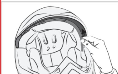
Inserte la parte de plástico encajándola en los huecos correspondientes del armazón de plástico.
