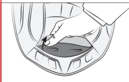
Entfernen Sie die Rückseite durch Ziehen am hinteren Teil, um die Kunststoffknöpfe auszuhaken.
