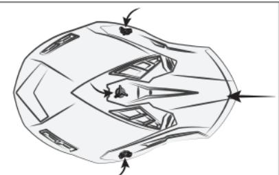
Coloque a viseira e fixe através dos parafusos e arruelas. Remova os três parafusos na viseira e nas arruelas.
