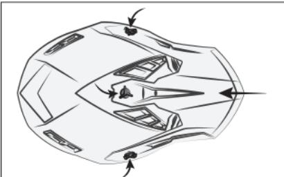
Setzen Sie das Visier auf und befestigen Sie es mit den Schrauben und den Unterlegscheiben.
